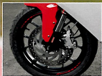
Dem Superbike abgeschaut: Geprägte Gabelbrücke mit feiner USD-Gabel, radial montierter Vierkolben-Festsattel im Vorderrad
