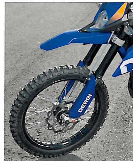
Vorderradführung durch hochwertige Paioli USD-Gabel. Wave-Scheibe und Radialsattel.
