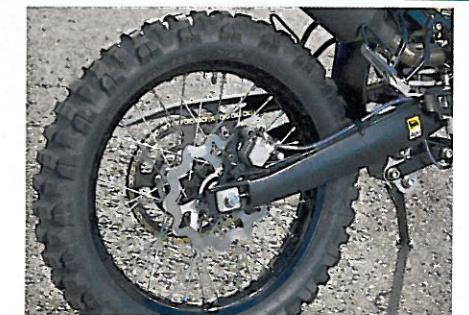
Über Hebel angelenktes Zentralfederbein. Speichenräder in vernünftigen Dimensionen.
