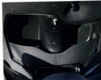
Tiefes Staufach im Beinschild, vom Zentralschloss bedient
