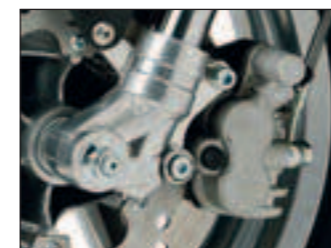
Herkömmlicher Doppelkolbenschwimmsattel im Vorderrad
