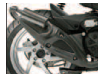
Rennauspuff mit carbonummanteltem Schalldämpfer
