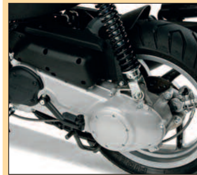
Klassiker: Antriebseinheit in Triebsatzschwingen-Bauweise mit einem in der Vorspannung vierfach verstellbaren Federbein
